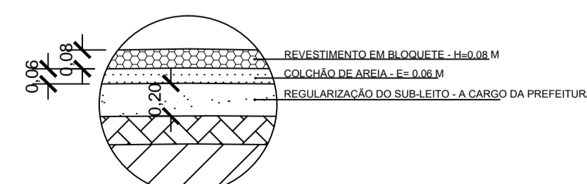
DETALHE 2 - CORTE CAMADAS - BLOQUETE SEM ESCALA
